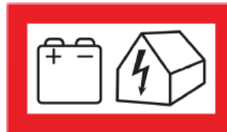
Bild C.2 – Hinweisschild Speichersystem ohne Eigenerzeugungsanlage
