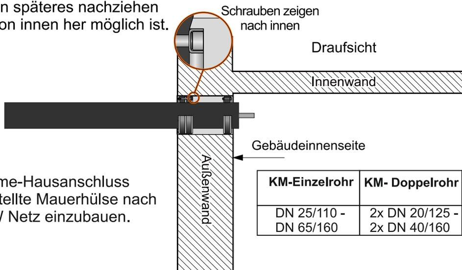
Für den Fernwärme-Hausanschluss ist eine bereitgestellte Mauerhülse nach Vorgabe der LSW Netz einzubauen.
