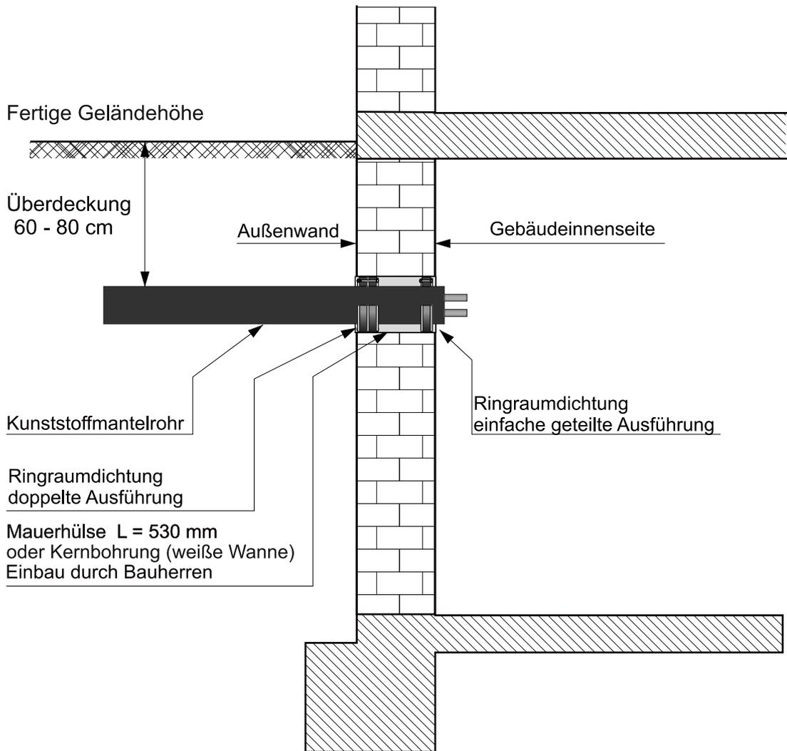
Die Ringraumdichtungen sind so zu montieren, dass ein späteres nachziehen der Dichtungen von innen her möglich ist.
