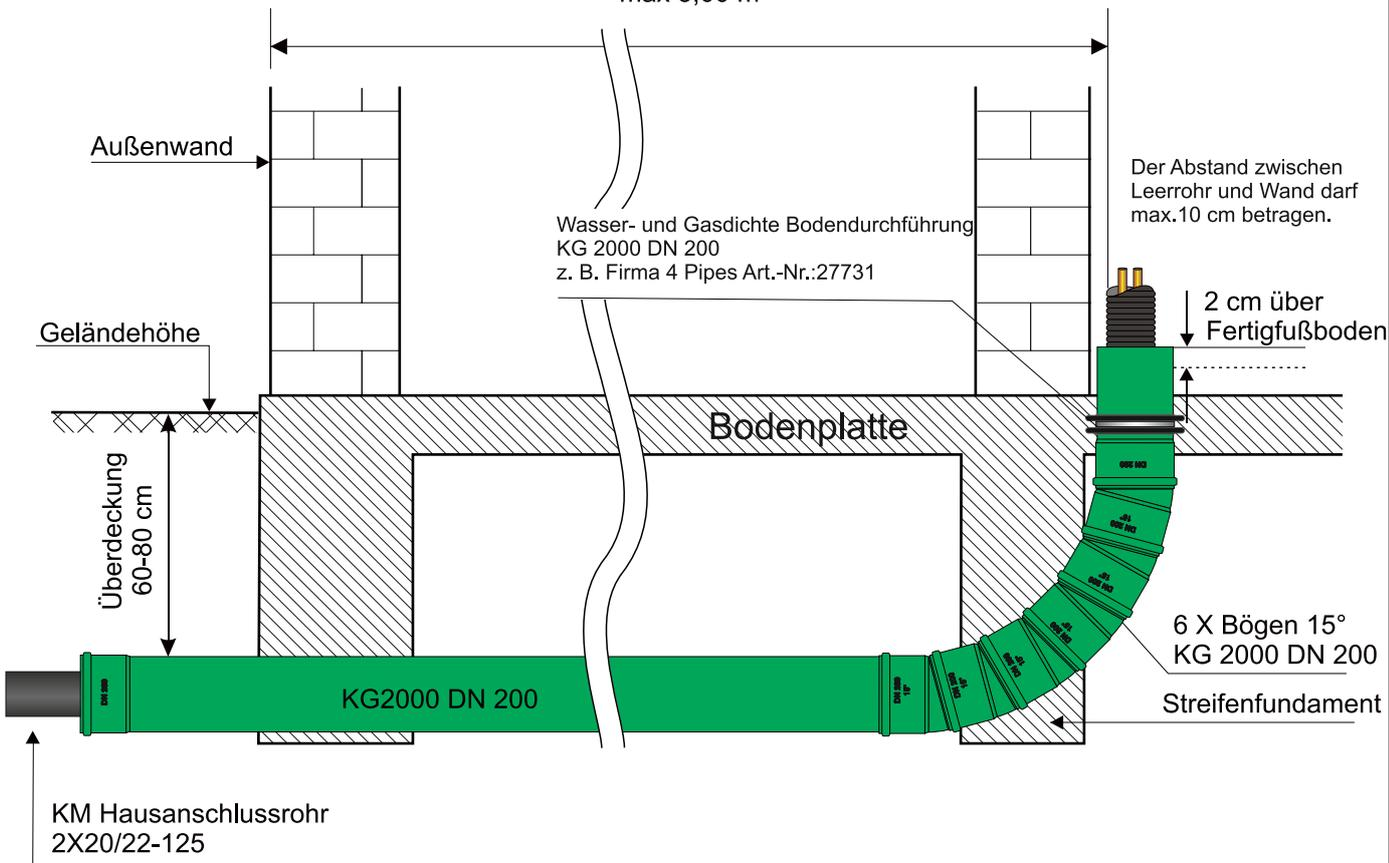
Für den Fernwärme-Hausanschluss ist ein Leerrohr DN 200 nach Vorgabe der LSW Netz zu verlegen.
